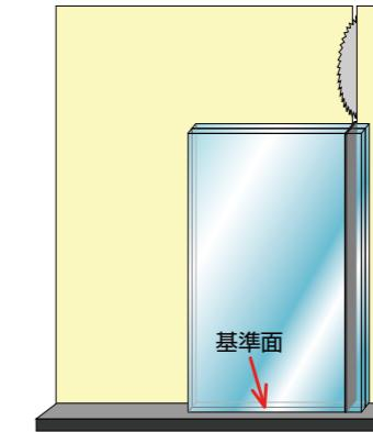
2) 重ね切断した短面(基準面)を定規面(パネルソーの場合は水平定規)にしっかりと押しあて、重ねた状態で3~5mm程度耳取り切断する。
