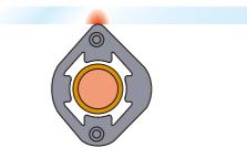
●大きなRで加熱すると、接点が大きいので熱がしっかり伝わりますので厚板に適しています。
