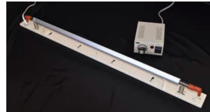
●プラスチック板の直線折り曲げ用ヒーターです。
