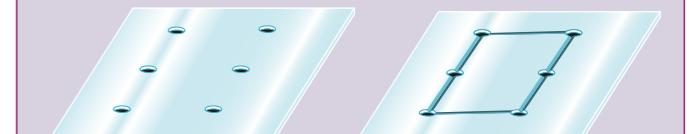
①材料が乗る部分の内側に、吸着用の穴を開けます。
